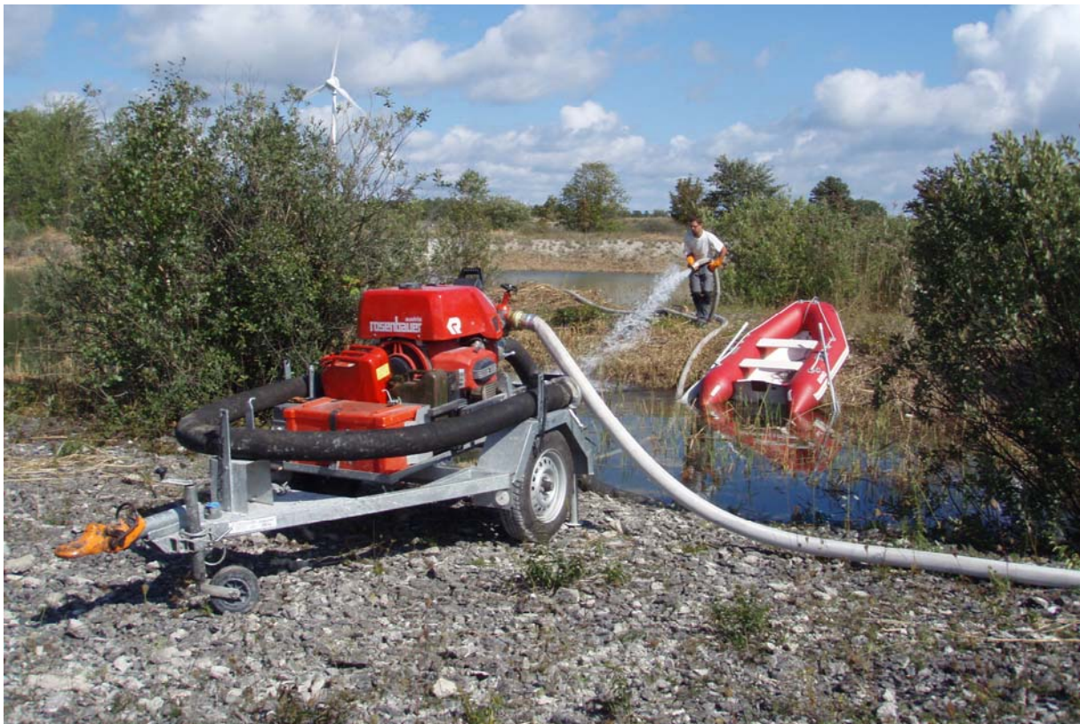
Figur 7. En kraftfull brandpump med hög kapacitet förenklade arbetet vid spolning av stränder och andra svårbehandlade områden i anslutning till kalkbrotten. Foto Josefin Sundin
