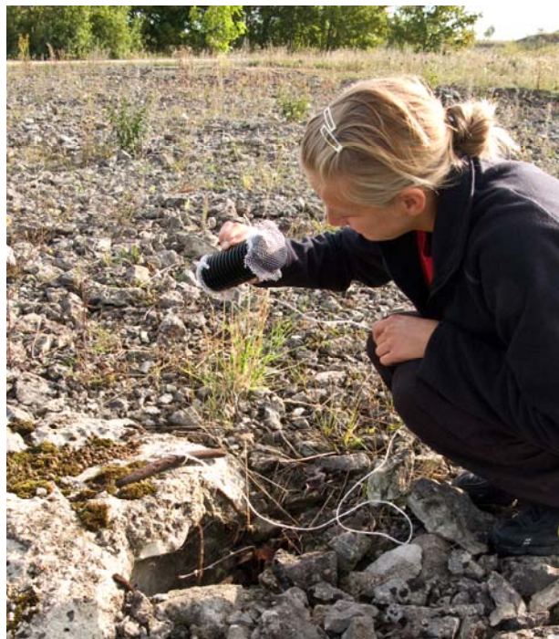
Figur 9. Test av giftverkan i vattenfylld husgrund i anslutning till kalkbrotten med hjälp av nedsänkning av flodkräfta i perforerad plasttub. Foto Nils Ljunggren
